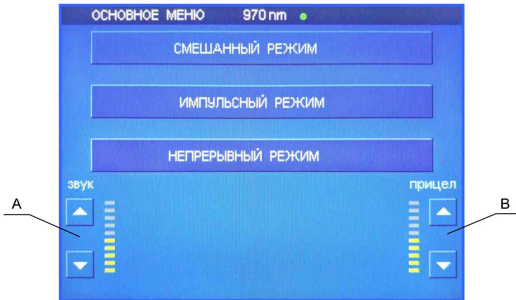
Рис. 1. Вид экрана **ОСНОВНОЕ МЕНЮ** (аппарат с одним рабочим каналом)
