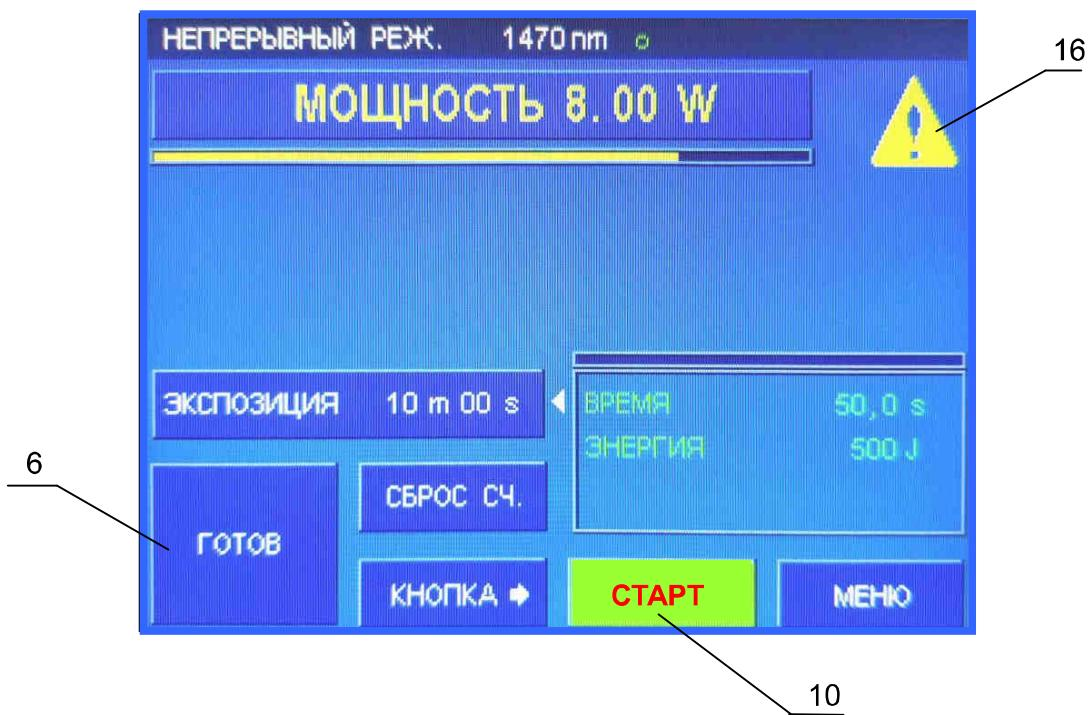
Рис.6. Вид экрана при нажатой кнопке ПОДГОТОВКА.
